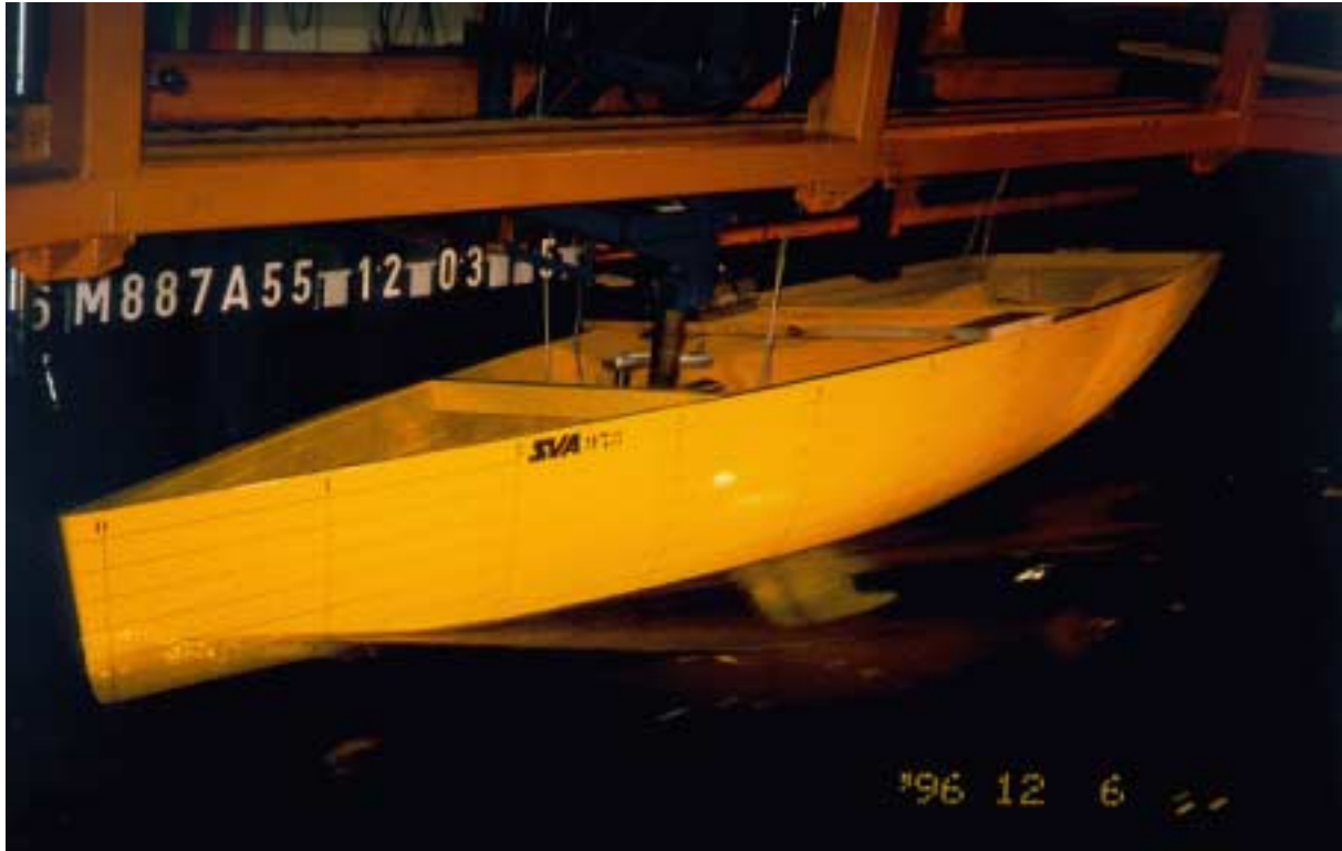
Abb. 12: Schleppversuchsmodell im Maßstab 1:2 des Segeldynamometers
