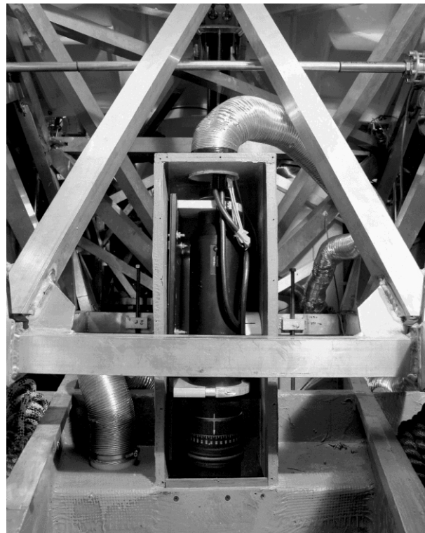
Abb. 10: LDV-Meßsystem im Vorschiff für Voraus- und Quergeschwindigkeit
