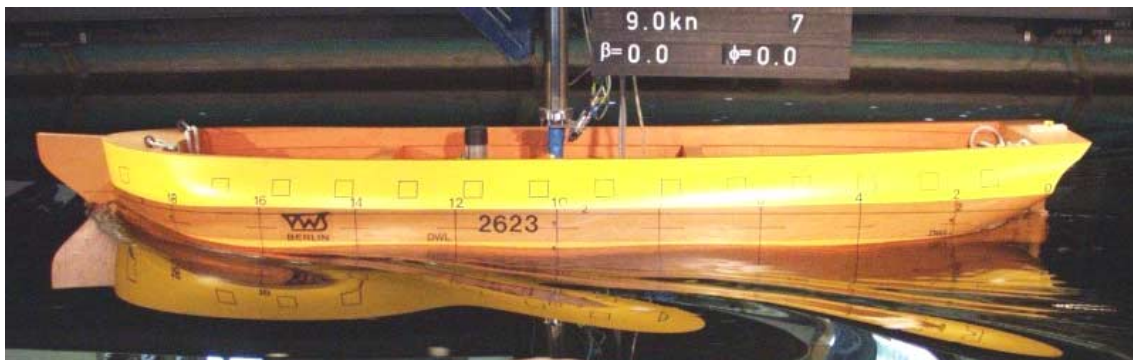
Abb. 8. Wellenbild für Bellona (Wave pattern of Bellona )
