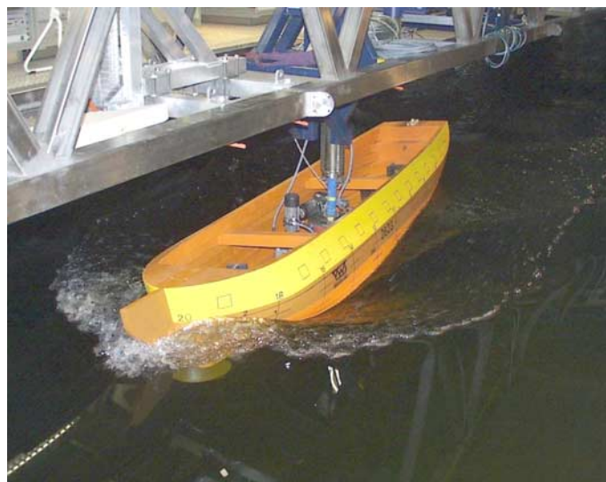
Abb. 9. Versuche mit Krängung und Abdrift für Bellona (Tests with heel and yaw for Bellona )
